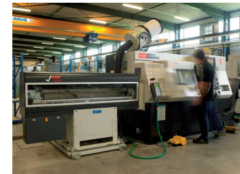
draaibank met freesmogelijkheden en materiaalaanvoer voor totaalbewerking
