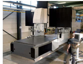
6-assige portaal freesmachine: bereik 4.000 x 2.300 x 1.100 mm
